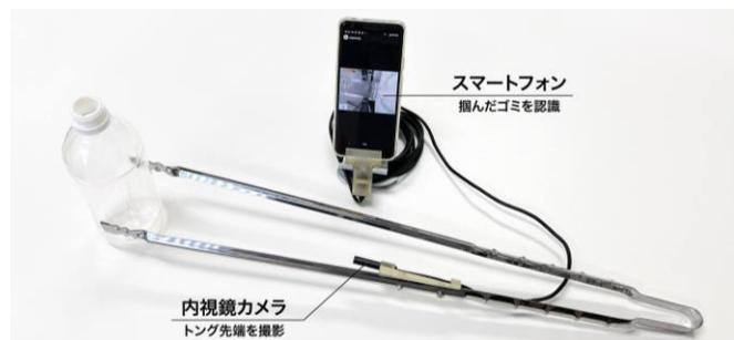
IoT tongはごみを拾うだけでごみの種類・位置情報を収集できるシステムである。ごみの種別の判定は弊社独自のAIを用いて行う。IoT tongで収集したデータを基にごみが多い場所を特定するアルゴリズムで、ごみ箱の設置場所の提案を行う。現在は特許を出願中。
